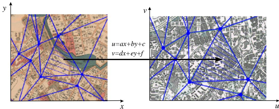
図 - 1 TIN とアフィン変換を統合した幾何補正
